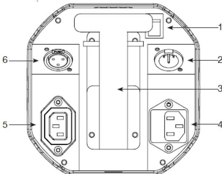
1. Interruttore On/Off della batteria: utilizzato per attivare l'alimentazione batteria. È inoltre necessario attivare la funzione LOAD (carico) (vedere a pagina 17 "Impostazione Load").
